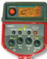
Opcionalmente puede tener radio control con indicador de carga digital
